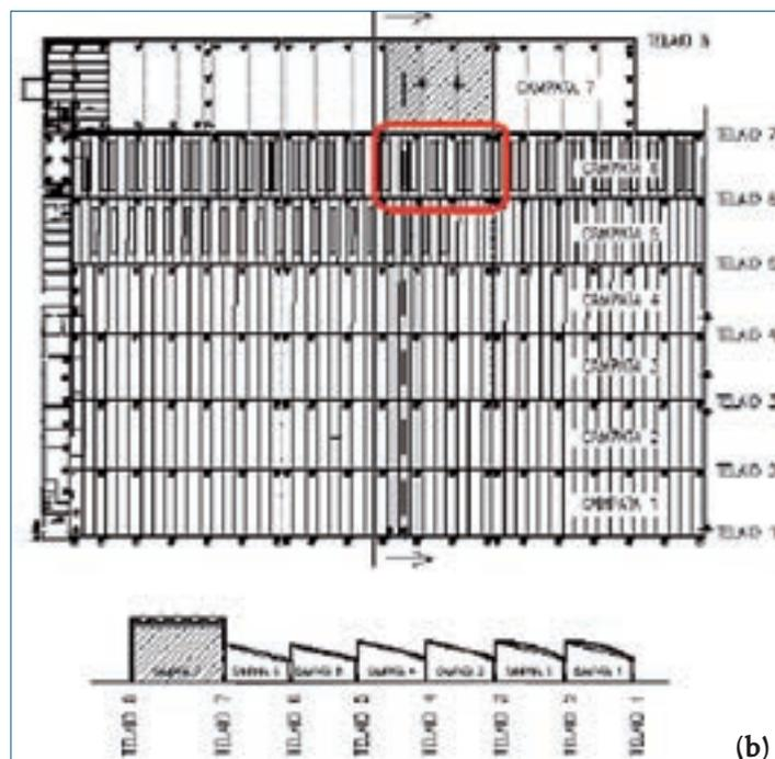
Figura 11: Prova di rilascio dinamico campata 6 corpo di fabbrica 22. (a) geometri a della prova. (b) individuazione della posizione della prova
